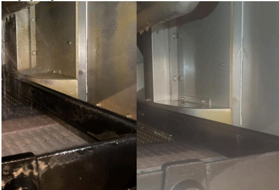
Reduzierte Biofilmbildung auf Oberflächen im Tunnelpasteur bei Wasserbehandlung mit organischem Biozid (li.) und mit dem vor Ort hergestellten Biozid (Bild: Innowatech).
