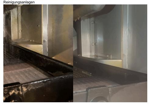
Reduzierte Biofilmbildung auf Oberflächen im Tunnelpasteur bei Wasserbehandlung mit organischem Biozid (Ii.) und mit dem vor Ort hergestellten Biozid (Bild: Innowatech).
