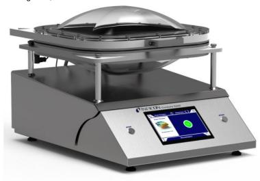
Die Geräte prüfen zerstörungsfrei die Dichtheit von z. B. Kaffeeverpackungen (Bild: Inficon).
