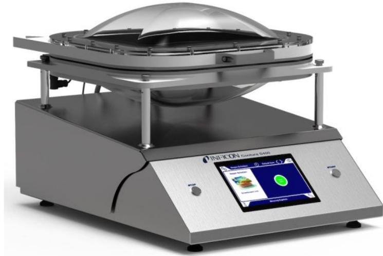
Die Geräte prüfen zerstörungsfrei die Dichtheit von z. B. Kaffeeverpackungen (Bild: Inficon).
