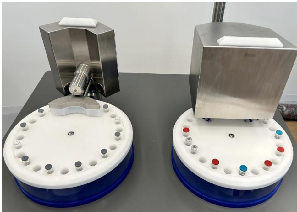
Beispiel für eine Deckelinspektionslösung mit maschineller Bildverarbeitung (Bild: Omron).
