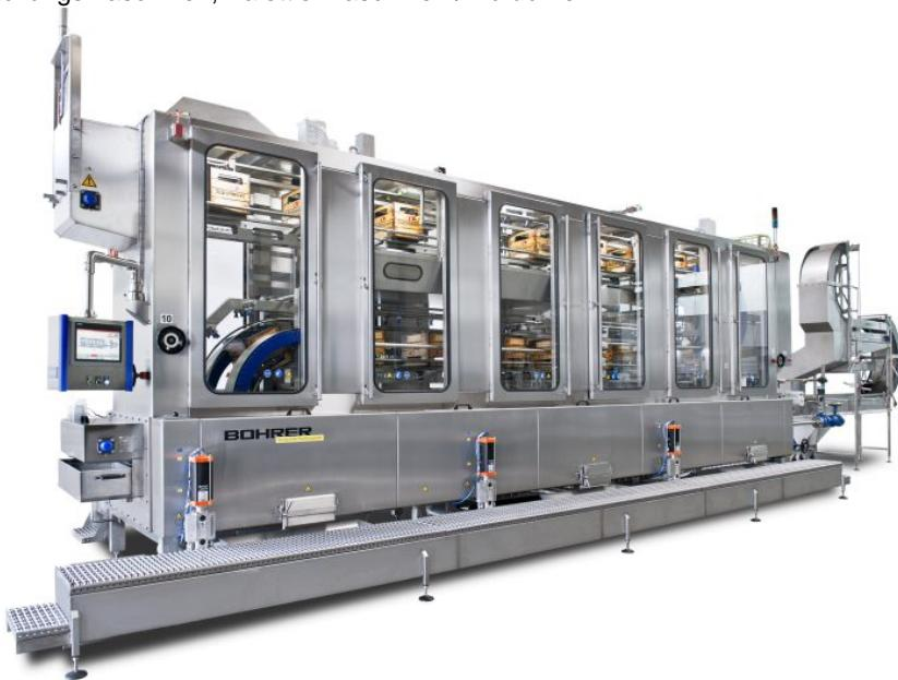
Bohrer hat seine erste, sich komplett motorisch einstellende Tauchbad-Kastenwaschmaschine konstruiert und gefertigt.
