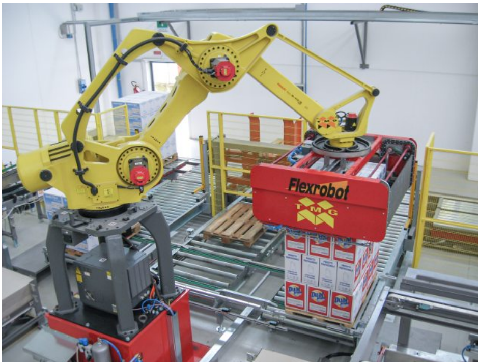
Anthropomorpher Palettierroboter (Bild: Procme).
