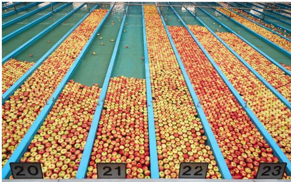
In der Sortieranlage werden die Äpfel automatisch in wasserführenden Kanälen nach den entsprechenden Sortierkriterien abgelegt (Bild: Leuze).
