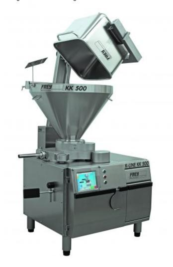
Mit einem Kreiskolbensystem arbeitet die »K«-Line von Frey. Sechs umlaufende Kolben
