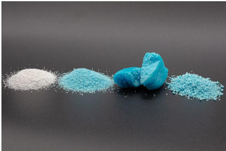
Zeitsparend: Bei diesem Beispiel wurde Zucker in nur einem Mischer trockengemischt, mit Maltodextrin als Binder granuliert, mit einem Farbstoff gecoatet, durch Zugabe von Flüssigkeit plastifiziert und durch anschließendes Trocknen wieder in die Granulatphase überführt (Bild: Eirich).
