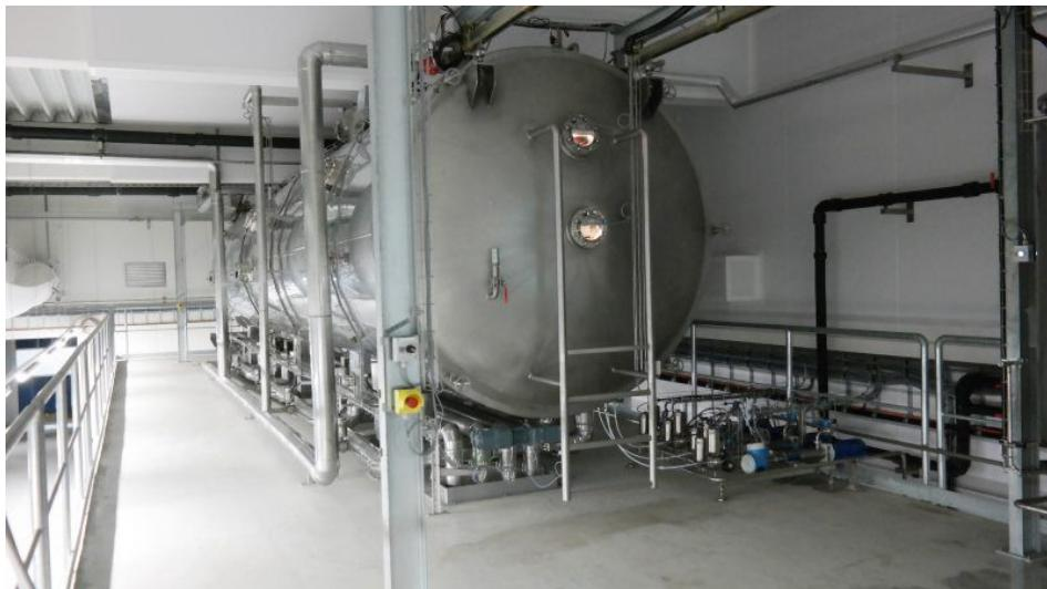
Im Vakuum-Bandrockner wird das vorkonzentrierte Produkt auf einem Förderband durch eine Vakuumkammer geführt und durch verschiedene Heizzonen geleitet (Bild: Devex).
