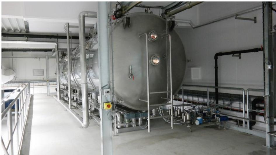
Im Vakuum-Bandtrockner wird das vorkonzentrierte Produkt auf einem Förderband durch eine Vakuumkammer geführt und durch verschiedene Heizzonen geleitet (Bild: Devex).
