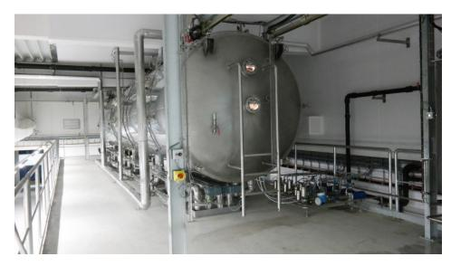
Im Vakuum-Bandtrockner wird das vorkonzentrierte Produkt auf einem Förderband durch eine Vakuumkammer geführt und durch verschiedene Heizzonen geleitet (Bild: Devex).
