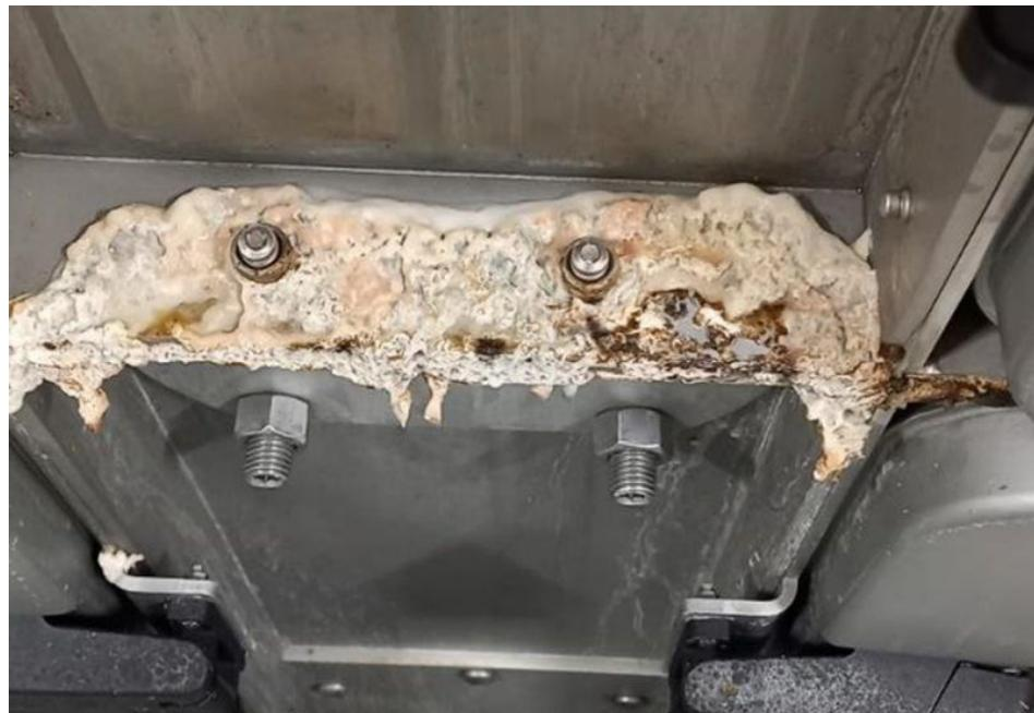
Gefahr für Produkt und Personal: Dieser Biofilm wuchs nach der Reinigung auf einer feuchtwarmen Edelstahlfläche, sofortige Reinigungsmaßnahmen mussten getroffen werden (Bild: Lars Peuker).
