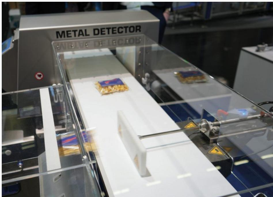
Gelangen Bruchstücke der metalldetektierbaren Bedienteile in den Prozess, können Metalldetektoren die Fremdkörper zuverlässig ausselektieren – auch wenn diese für das bloße Auge unsichtbar sind (Bild: Kipp).
