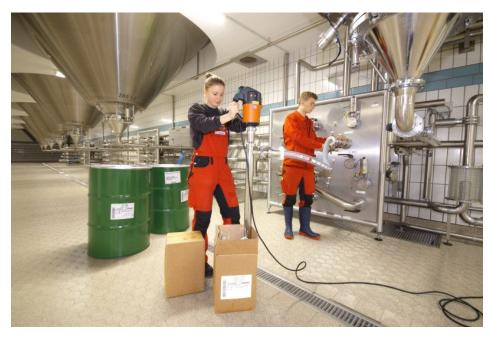
Um das Konzentrat aus dem Fass durch die circa zehn Meter hohe Steigleitungen zu fördern, ist ein hoher Pumpendruck nötig (Bild: Rothaus).
