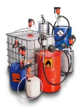
Fasspumpen sind für einen häufigen Medienwechsel ausgelegt und passen durch ihr schlankes Förderrohr mit 40 bis maximal 50 Millimetern Durchmesser auch durch enge Behälter und Fassöffnungen (Bild: Rothaus).
