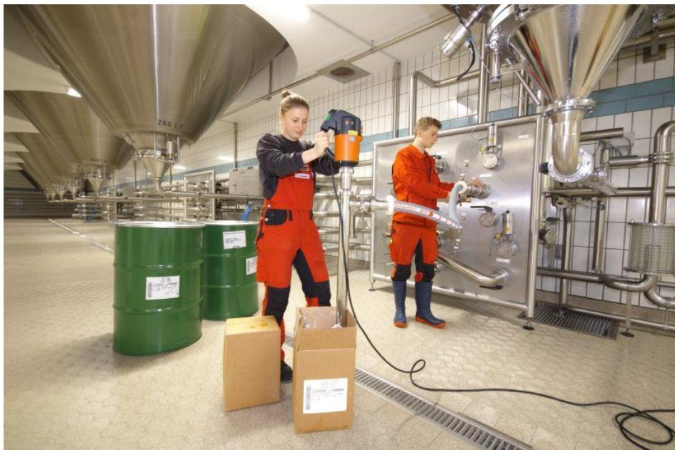
Um das Konzentrat aus dem Fass durch die circa zehn Meter hohe Steigleitungen zu fördern, ist ein hoher Pumpendruck nötig (Bild: Rothaus).
