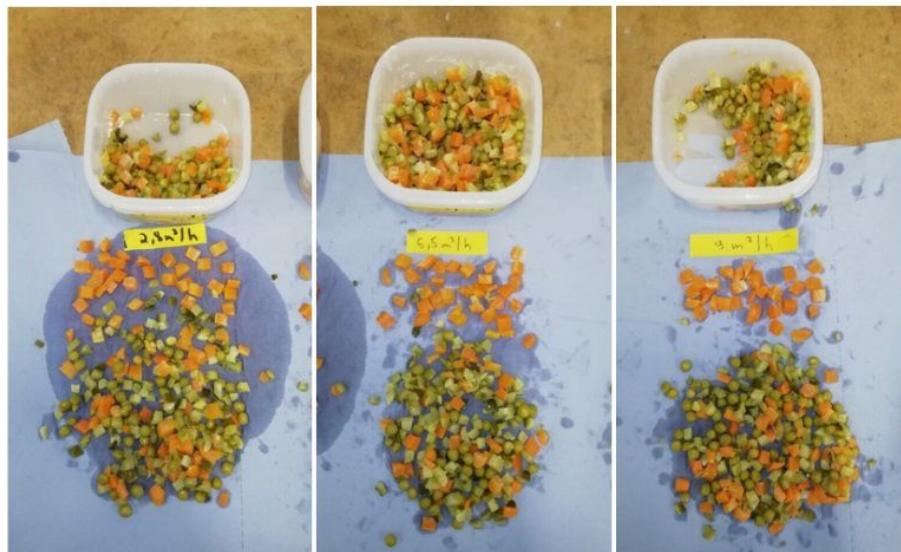
Alle drei Versuche mit Förderraten von 2,8, 6,5 und 9,0 Kubikmetern pro Stunde zeigten, dass die Stückigkeit der Gemüseeinlage erhalten bleibt (Bild: Wangen Pumpen).
