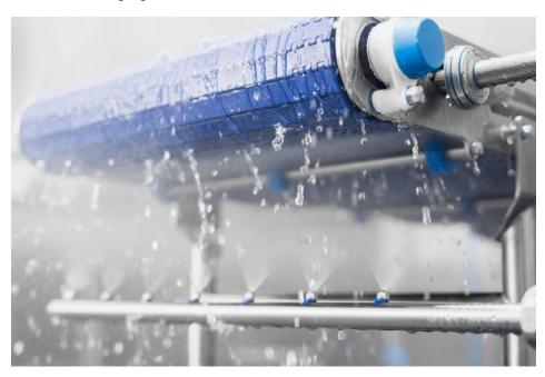
Das Modulband-Gesamtkonzept verbessert die Hygiene- und Produktsicherheit. Außerdem trägt es zur Senkung des Wasser- und Reinigungsmittelverbrauchs bei (Bild: Habasit).
