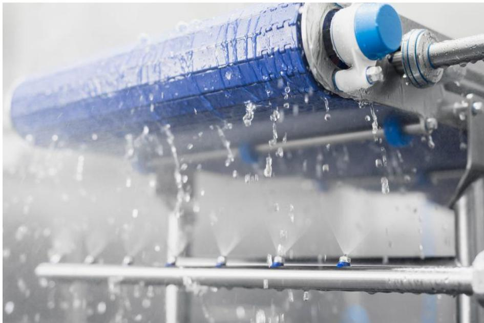
Das Modulband-Gesamtkonzept verbessert die Hygiene- und Produktsicherheit. Außerdem trägt es zur Senkung des Wasser- und Reinigungsmittelverbrauchs bei (Bild: Habasit).
