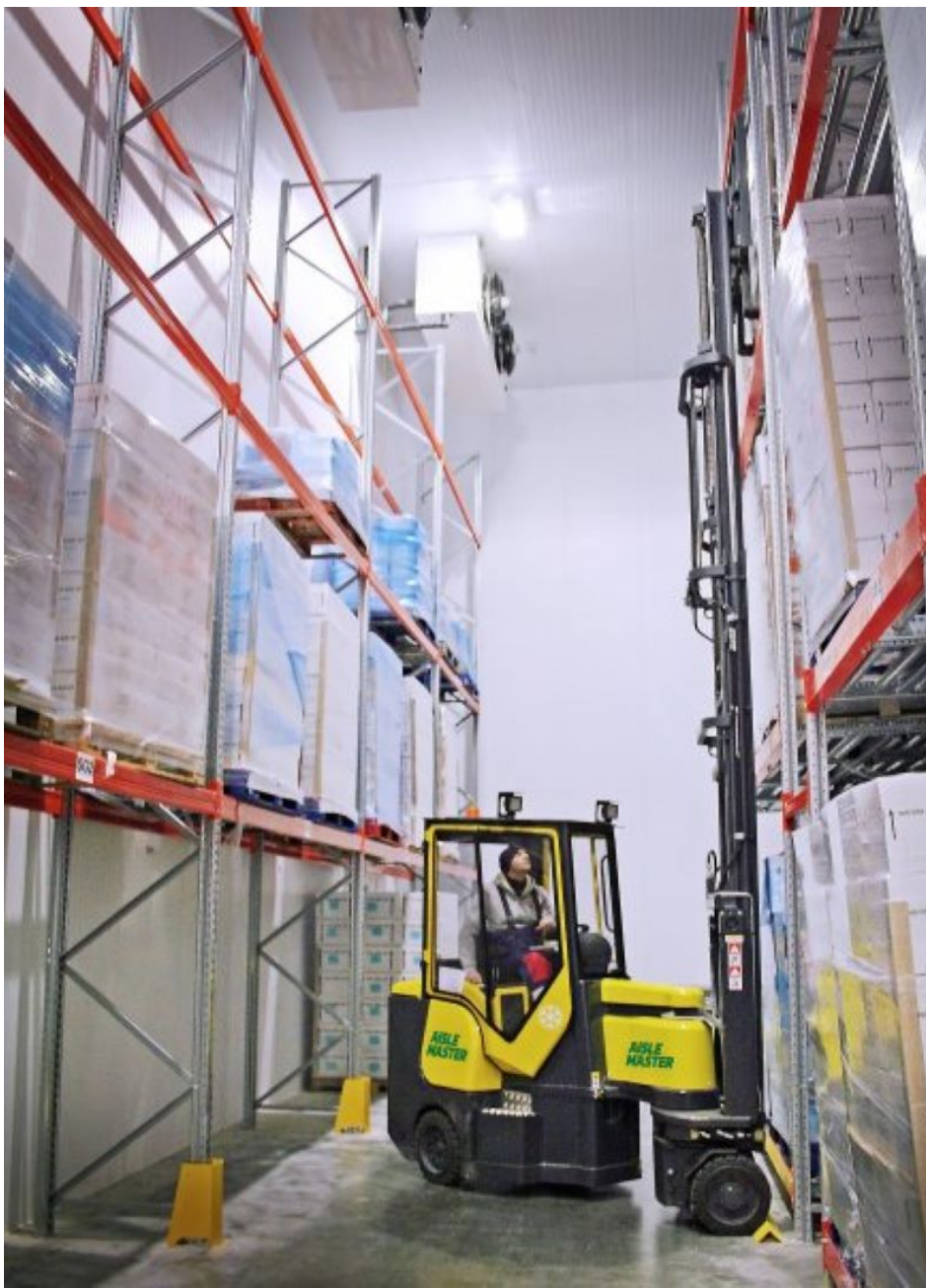
Der Schmalgang-Gabelstapler »Aisle Master« verbessert die Entladung, Handhabung und Lagerung von Lebensmitteln und Getränken (Bild: Combilift).
