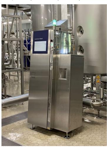
Messung des Alkoholgehalts online oder im Fertigsirup-Batch (Bild: Dausch).
