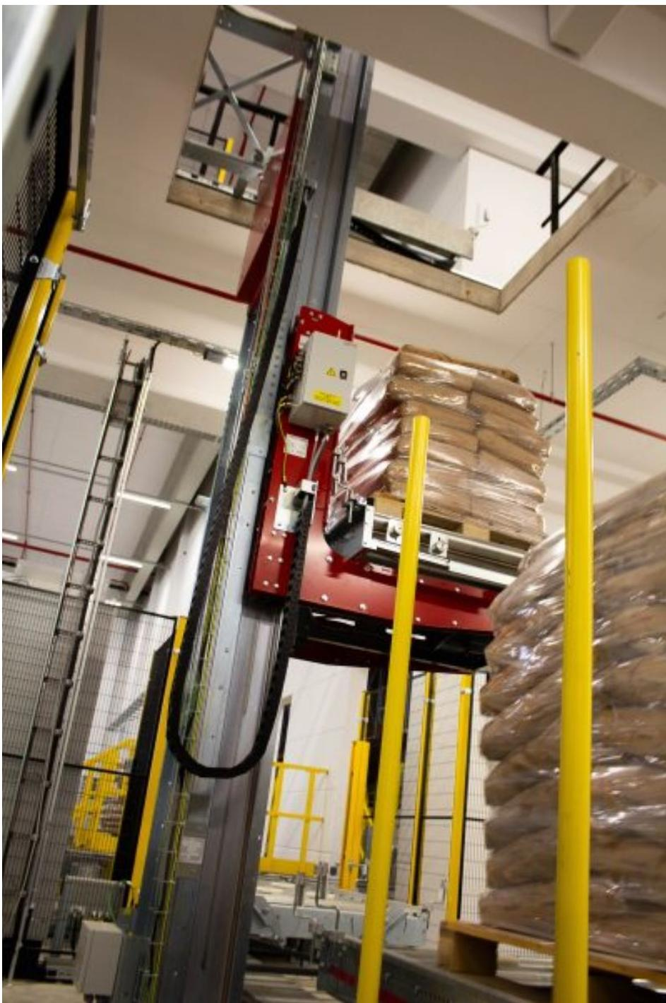
Für die unterschiedlichen Staufachgrößen und Bedienelemente wurden vier doppeltiefe Regalbediengeräte des Typs »Vectura« integriert (Bild: Swisslog).
