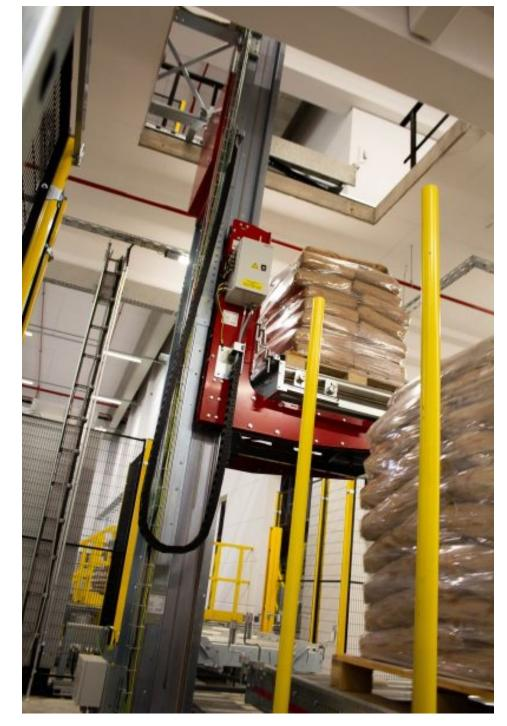
Für die unterschiedlichen Staufachgrößen und Bedienelemente wurden vier doppeltiefe Regalbediengeräte des Typs »Vectura« integriert (Bild: Swisslog).
