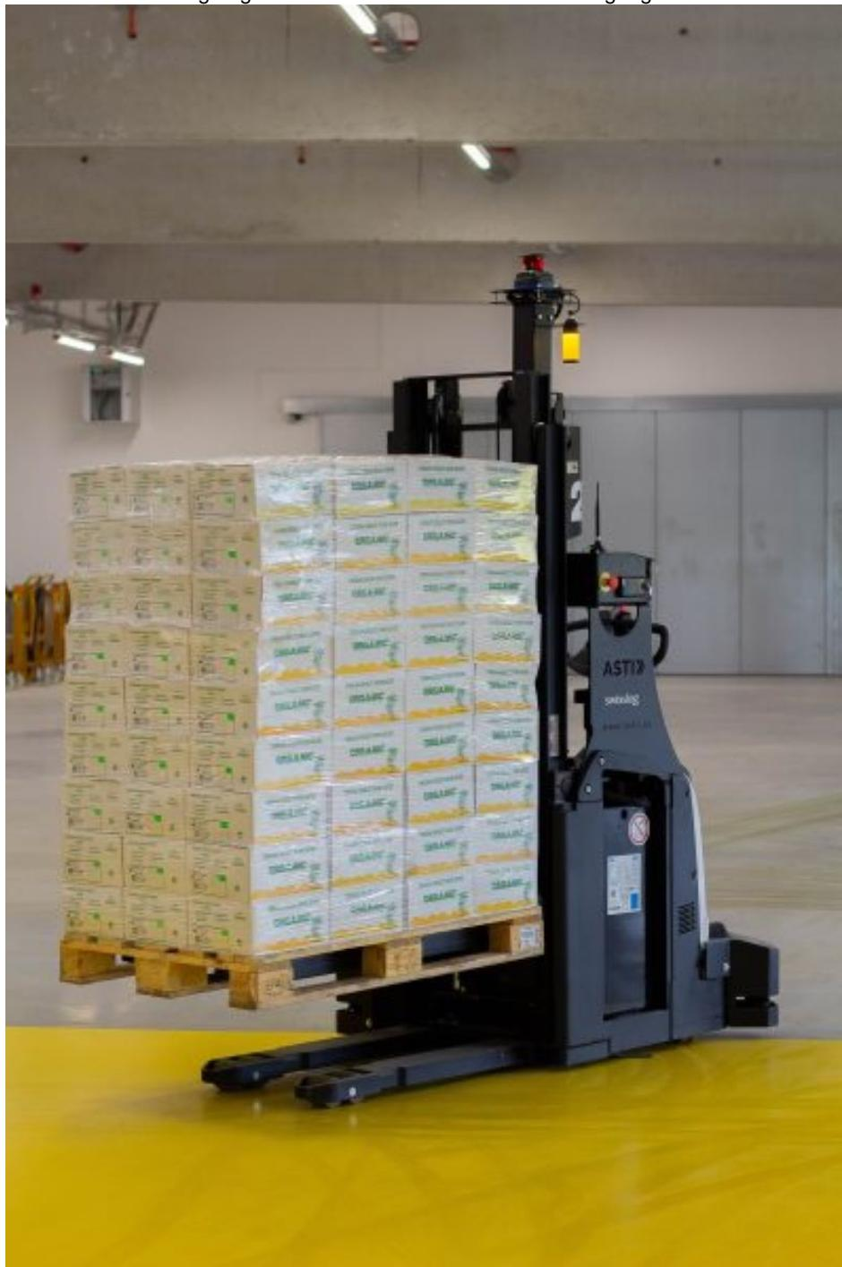
Das fahrerlose Transportsystem (FTS) mit drei autonomen Fahrzeugen gewährleistet die automatische Versorgung der Produktion (Bild: Swisslog).
