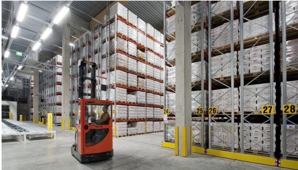
Die Palettenregale sind auf mobilen Fahrgestellen montiert und werden auf im Boden verankerten Schienen bewegt (Bild: Dexion).
