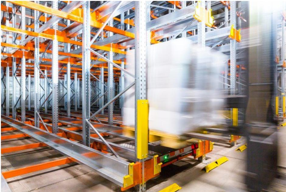
Als Einfahr-, Einschub- oder Palettendurchlaufregal kann das »Pallet Shuttle System« in verschiedenen Branchen und Anwendungen eingesetzt werden (Bild: Dexion).
