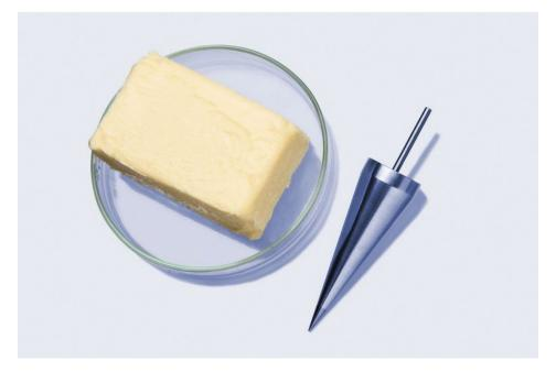
Zur Messung der Konsistenz von Margarine und anderen Lebensmittelproben wird das Penetrometer empfohlen. Bei Margarine kommt ein 45 Gramm schwerer Aluminiumkonus mit 20-Grad-Spitze zum Einsatz (Bild: Anton Paar).
