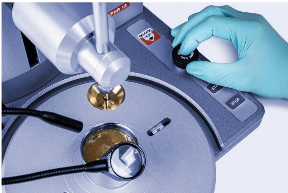
Das Penetrationsmessgerät ermöglicht die schnelle und einfache Prüfung der Konsistenz vieler Lebensmittel (Bild: Anton Paar).
