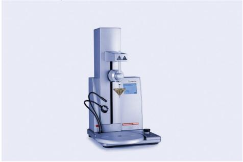
Das Penetrometer »PNR 12« zeigt den C-Wert direkt nach Abschluss der Messung an (Bild: Anton Paar).
