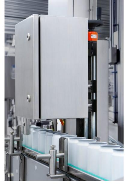
Die neue, nachrüstbare Erweiterung um »ECI+« ermöglicht eine zusätzliche Kontrolle des oberen Bereichs der Leerdosen (Bild: KHS).
