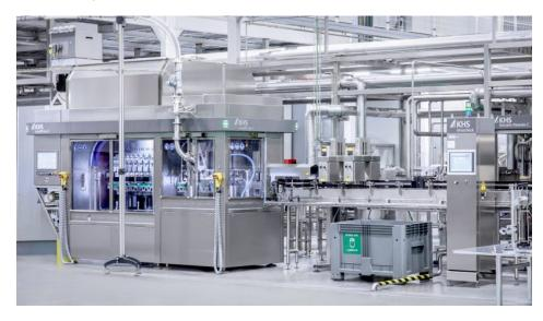
Liniengedanke im Blick: Im Zusammenspiel mit der leistungsstarken Verschließereinheit des Schweizer Partners Ferrum arbeitet der Dosenfüller mit einer Kapazität von bis zu 60.000 Dosen pro Stunde (Bild: KHS).
