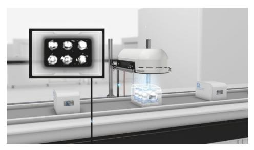
Mit dem radarbasierenden Bildgebungssystem werden Verpackungen auf Vollständigkeit, Unversehrtheit und Fremdkörper geprüft (Bild: Balluff).
