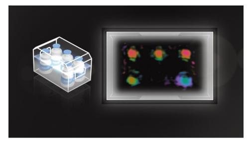
Mit dem 3D-Bildgebungssystem können auch fehlende Inhalte detektiert werden (Bild: Balluff).
