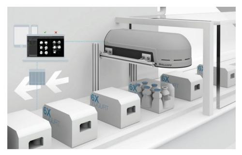
Auch Fehlmengen lassen sich mit dem »Radarlmager« schnell erkennen (Bild: Balluff).
