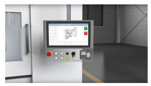
Dank kompakter Einbaumaße ist auch das Auswertegerät im Panel integrierbar (Bild: Euchner).
