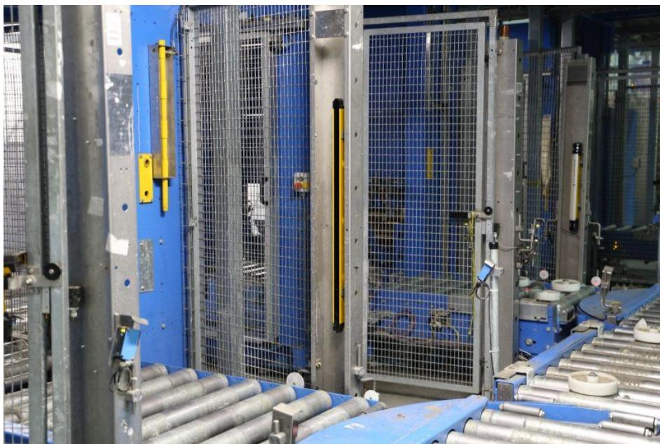
Teilweise mussten auch die bestehenden Sicherheitslichtgitter ausgetauscht werden. Als Ersatz kamen die Sicherheits-Lichtgitter »PSENopt II« von Pilz zum Zug (Bild: NÖM/Pilz).
