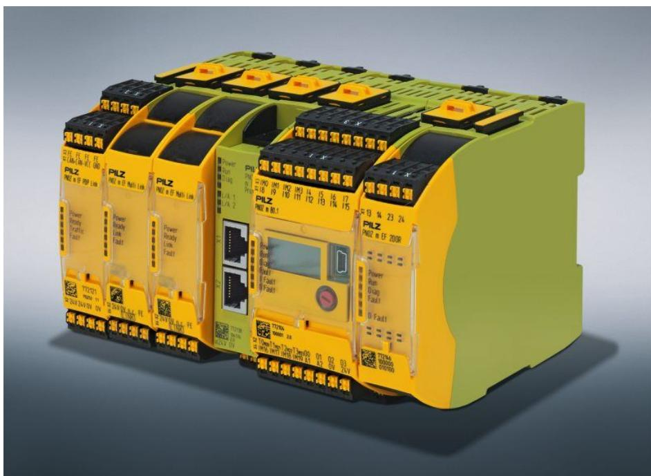
Bei Einzelstationen erfolgt die Muting-Kommunikation mit der übergeordneten SPS über die konfigurierbare Kleinsteuerung »PNOZmulti 2« (Bild: NÖM/Pilz).
