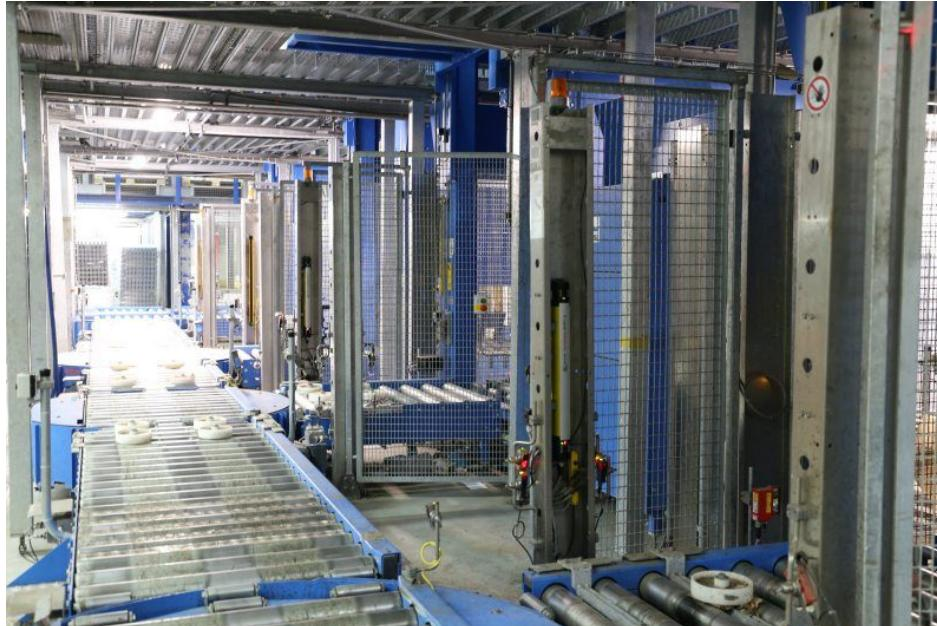
Insgesamt verfügt die NÖM über drei große Palettieranlagen, zwei davon wurden aktuell gemeinsam mit Pilz umgebaut und auf den aktuellen Stand der Sicherheitstechnik gebracht (Bild: NÖM/Pilz).
