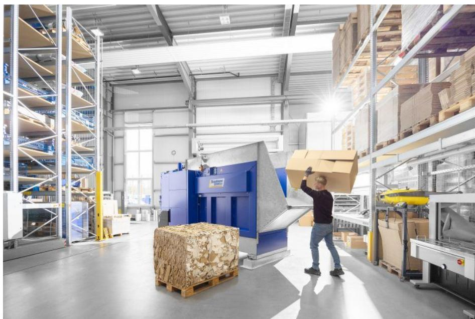
Die effiziente Ballenpresse verfügt über einen extragroßen Einfüllschacht, wodurch manuelle Vorzerkleinerungsarbeiten entfallen (Bild: Strautmann).
