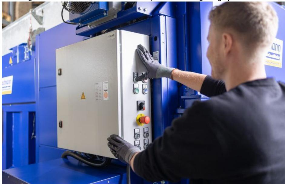
Zweihandbedienung für einen sicheren Ballenauswurf (Bild: Strautmann).
