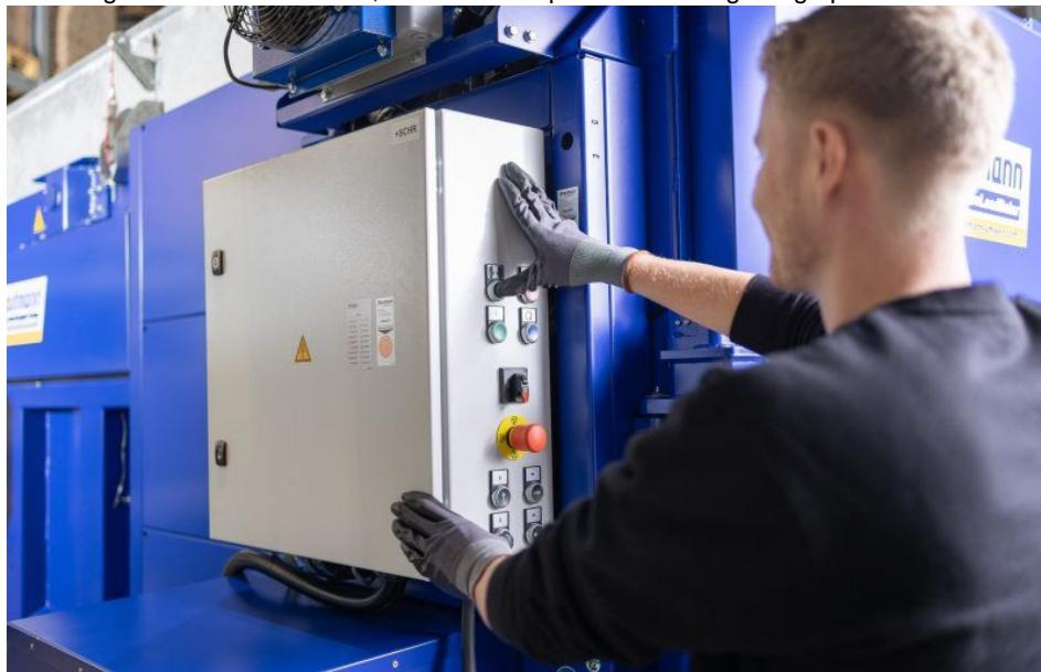
Zweihandbedienung für einen sicheren Ballenauswurf (Bild: Strautmann).
