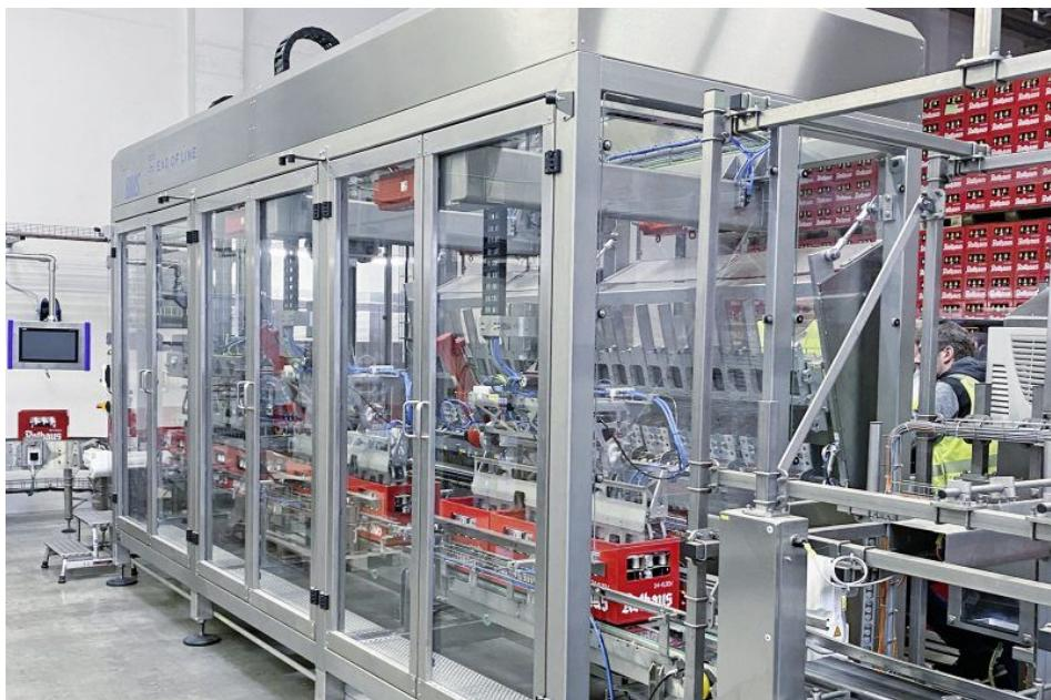
Der Maschinenprototyp kombiniert die Multipack-Applikation und die Etikettenausrichtung in einem gemeinsamen Maschinengestell (Bild: EOL).
