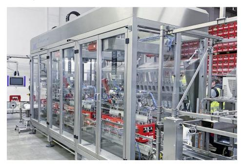
Der Maschinenprototyp kombiniert die Multipack-Applikation und die Etikettenausrichtung in einem gemeinsamen Maschinengestell (Bild: EOL).
