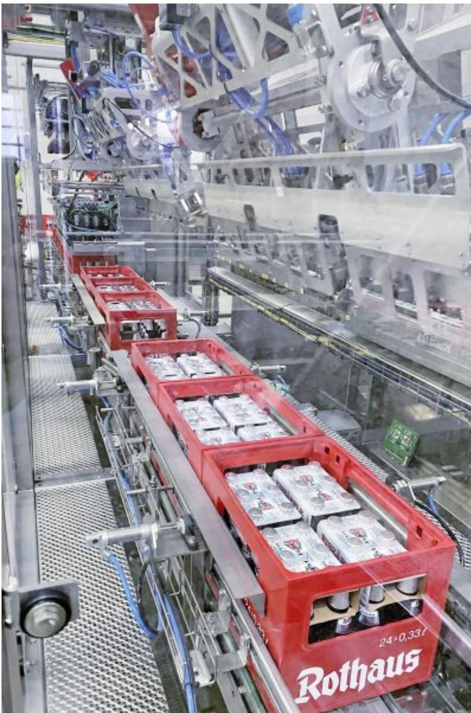
Innerhalb der Maschine werden an zwei Stationen jeweils drei Kästen ausgerichtet und mit den »TopClips« versehen. Der Prototyp erreicht dabei eine Maximalleistung von 27.000 0,33-Liter-Flaschen pro Stunde (Bild: EOL).
