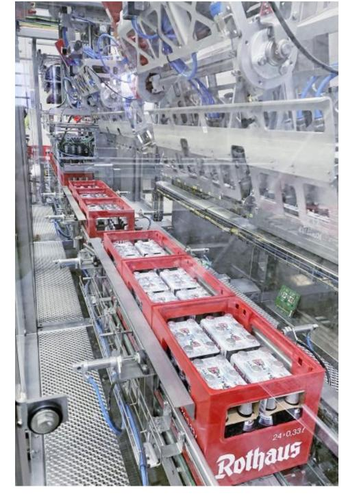
Innerhalb der Maschine werden an zwei Stationen jeweils drei Kästen ausgerichtet und mit den »TopClips« versehen. Der Prototyp erreicht dabei eine Maximalleistung von 27.000 0,33-Liter-Flaschen pro Stunde (Bild: EOL).
