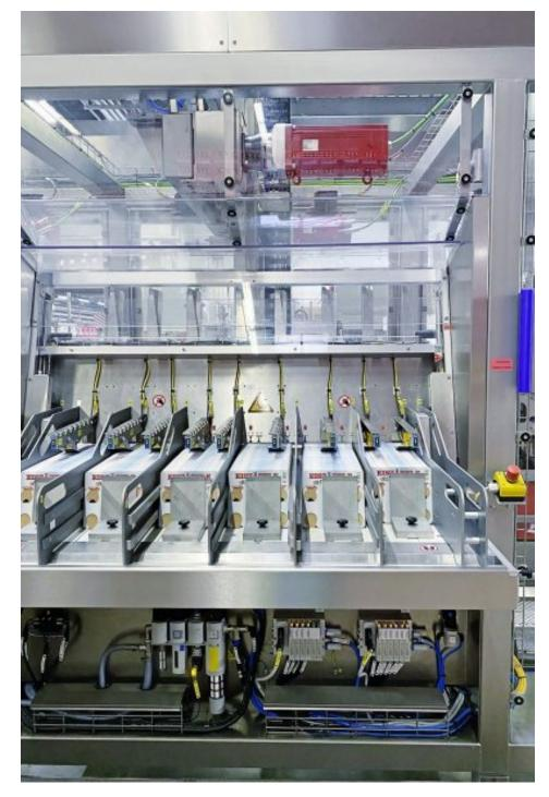
Neben dem »TopClip«-Greifer ist deren Magazin ebenfalls eine Neuentwicklung (Bild: EOL).
