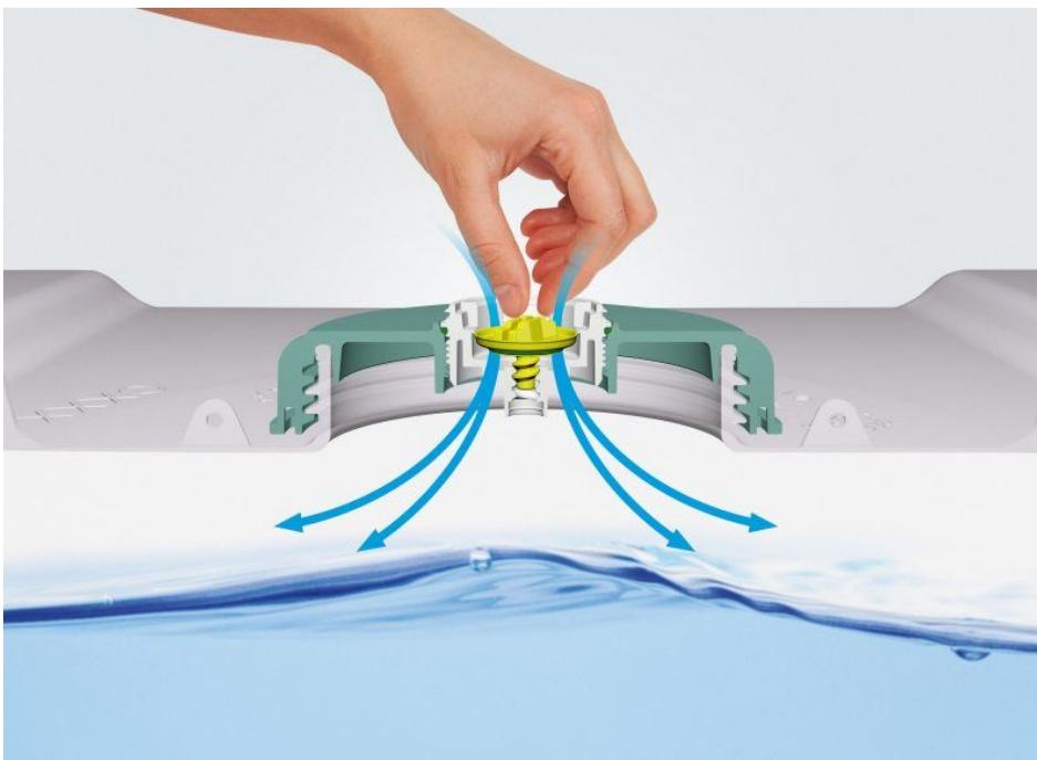
Der Stopfen dient der schnellen und sicheren Belüftung der IBC bei der Entnahme. So lassen sich IBC entleeren, ohne die Schraubkappe zu öffnen (Bild: Schütz).
