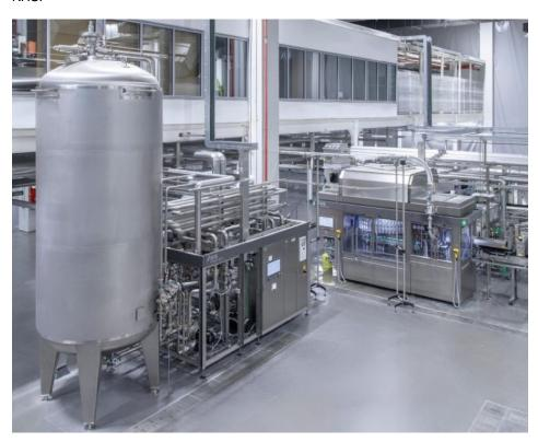
Im neuen Werk kommen moderne Prozess- und Fülltechnik zum Einsatz: links der Kurzzeiterhitzer, rechts der Dosenfüller (Bild: Frank Reinhold).
