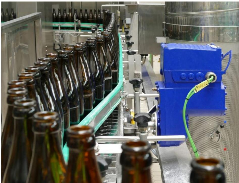
Die vollintegrierte Antriebseinheit vereinigt Synchronmotor, Getriebe und Frequenzumrichter in einem kompakten Gehäuse. Es wurde speziell für die horizontale Fördertechnik entwickelt und kommt in zahlreichen Brauereien zum Einsatz (Bild: SEW).
