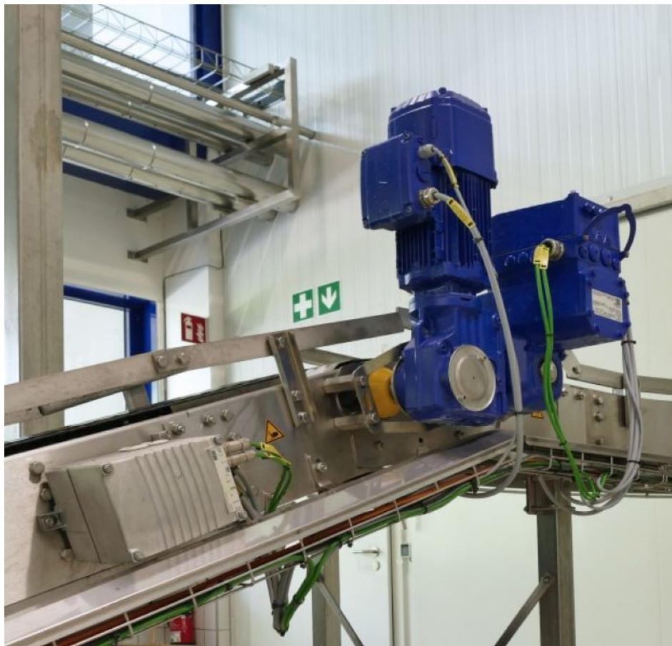
Für schräge Förderstrecken, die eine Bremse erfordern, kommen Standard-Asynchronmotoren zum Einsatz, die über motornaher Umrichter »Movimot flexible« gespeist werden (Bild: SEW).
