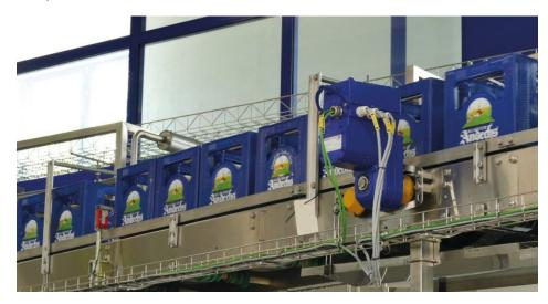
Auch der Antrieb der Förderbänder für den Transport der Bierkästen erfolgt durch die energieeffizienten Antriebseinheiten »Movigear performance«. Dank der neuen Antriebe wurde der Gesamtenergieeinsatz in der Füllerei verringert (Bild: SEW).
