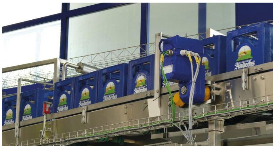
Auch der Antrieb der Förderbänder für den Transport der Bierkästen erfolgt durch die energieeffizienten Antriebseinheiten »Movicgear performance«. Dank der neuen Antriebe wurde der Gesamtenergieeinsatz in der Füllerei verringert (Bild: SEW).
