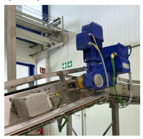
Für schräge Förderstrecken, die eine Bremse erfordern, kommen Standard-Asynchronmotoren zum Einsatz, die über motornahe Umrichter »Movimot flexible « gespeist werden (Bild: SEW).
