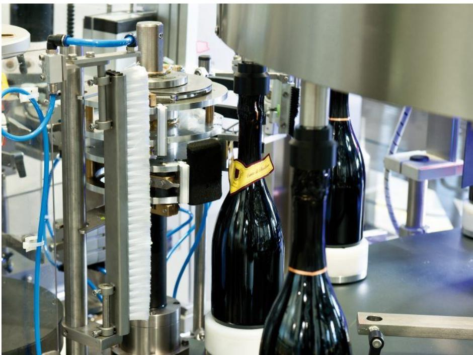
Für die Sektschleife ist der Etikettierer mit einem Nassleimaggregat ausgestattet (Bild: Gernep).
