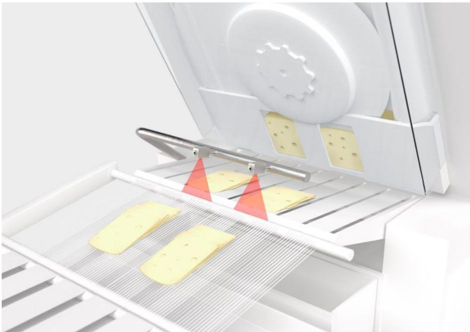
Die Lichttaster sind im Hygiene-Design ohne Bohrlöcher konzipiert und bieten sich für Einsatzbereiche mit direktem Lebensmittelkontakt an. Hier erkennen sie auch die Vorderkanten von Schnittwaren zuverlässig (Bild: Leuze).
