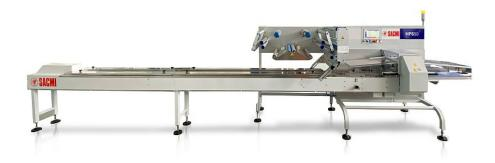
Die horizontale Schlauchbeutelmaschine eignet sich z. B. für die Verpackung hochwertiger Backwaren (Bild: Sacmi).
