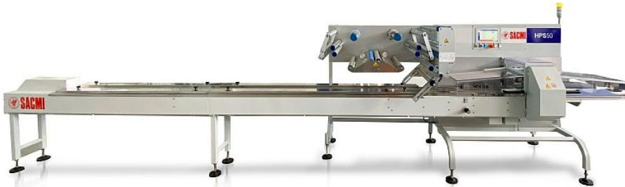
Die horizontale Schlauchbeutelmaschine eignet sich z. B. für die Verpackung hochwertiger Backwaren (Bild: Sacmi).
