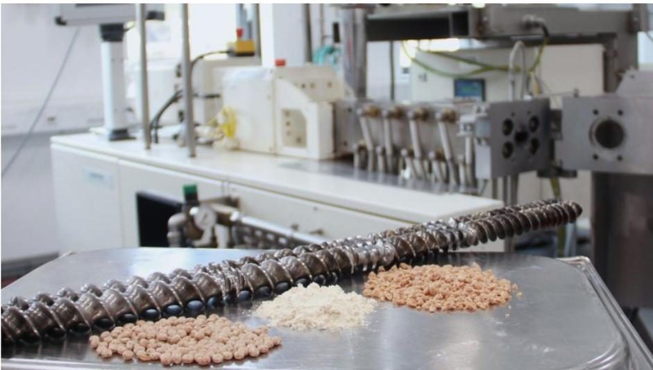
Mit der speziellen Extrusionstechnologie entstehen Fleischalternativen, z. B. aus Erbse, Lupine, Weizen oder Bohne mit einer faserigen und fleischähnlichen Textur (Bild: Fraunhofer IVV).
