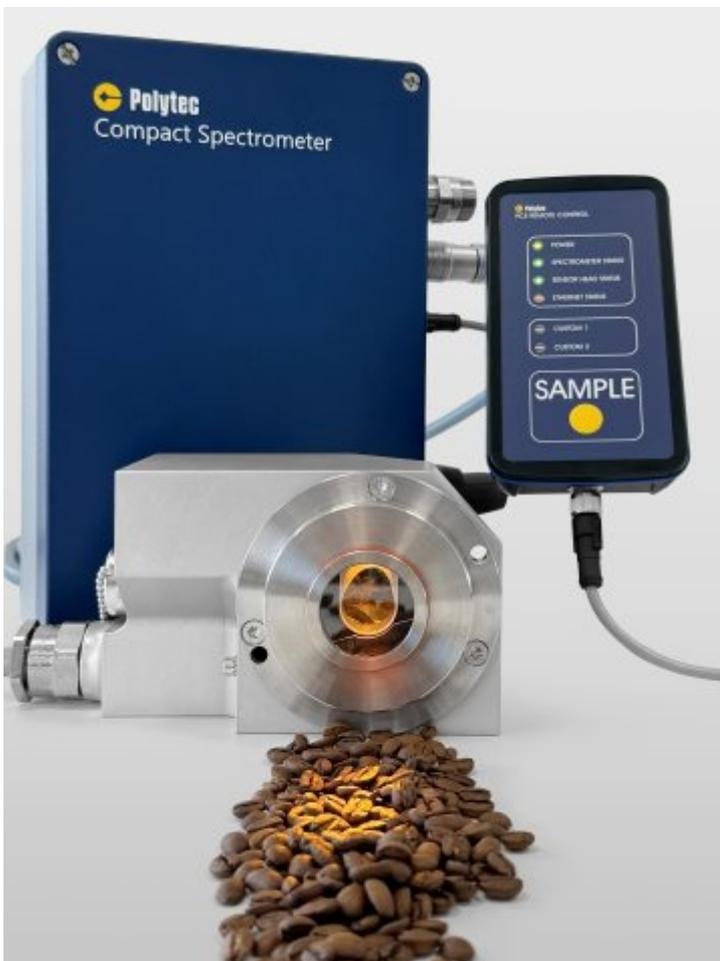
Mit dem Nahinfrarot-Spektrometer lässt sich der Gehalt von Fetten, Ölen, Proteinen oder Ballaststoffen einfach bestimmen (Bild: Polytec).
