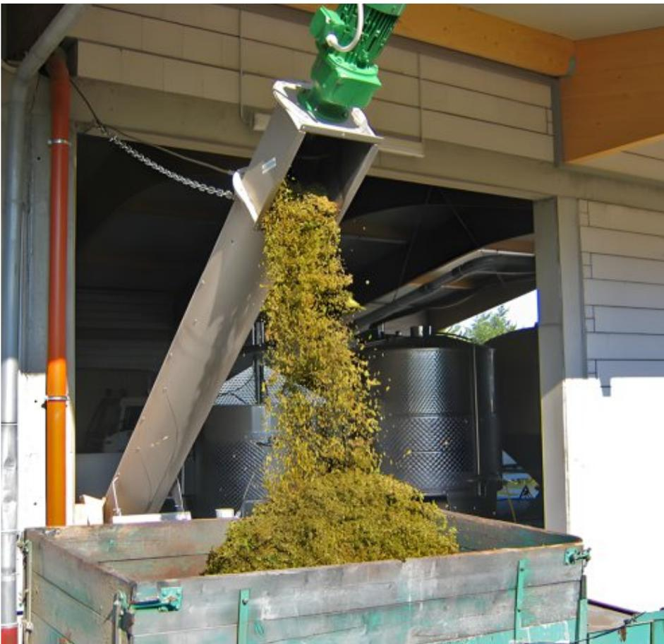
Dank durchdachter Konstruktion ermöglicht die achsenlose Fördertechnik eine reibungslose und effiziente Materialbewegung (Bild: Wildfellner).
