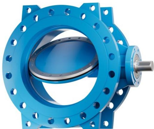
Durch die doppelt exzentrische Konstruktion der Absperrklappe werden Reibung und Verschleiß reduziert (Bild: Ebro Armaturen).
