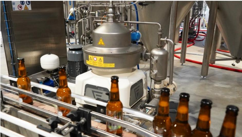
Der Tellerseparator sorgt für die finale Klärung der Biere (Bild: Flottweg).
