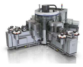
Der »EvoDECO«-Roll-Fed-Etikettierer von Sidel arbeitet mit zwei Stationen, die abwechselnd etikettieren.
