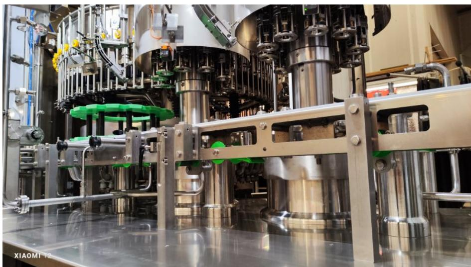
Die Vakuumfüller arbeiten schonend und genau (Bild: Hormes).
