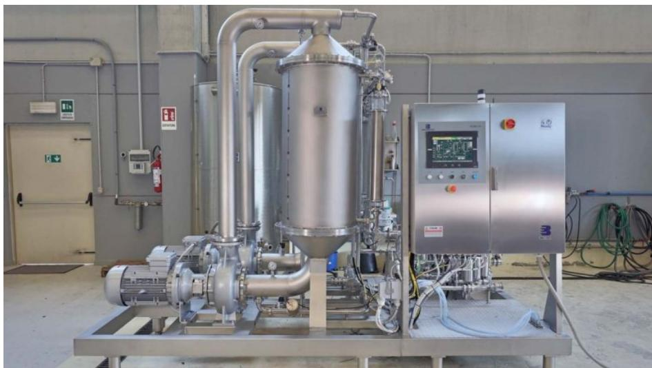
Die Keramikmembran-Crossflowfilter sind in Deutschland über Defratec erhältlich (Bild: Enomeccanica Bosio).
