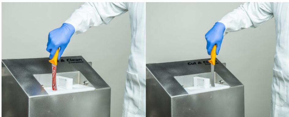
Das neue System zur Desinfektion von Schneidwerkzeugen entfernt jegliche Fett- und Eiweißverschmutzung (Bild: Fink Tec).
