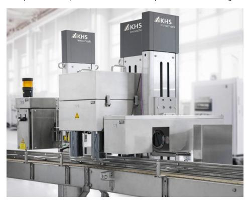
Die bewährte Lösung zur Verschlusskontrolle wurde mit einer KI-basierten Fehlererkennung ausgestattet (Bild: KHS).
