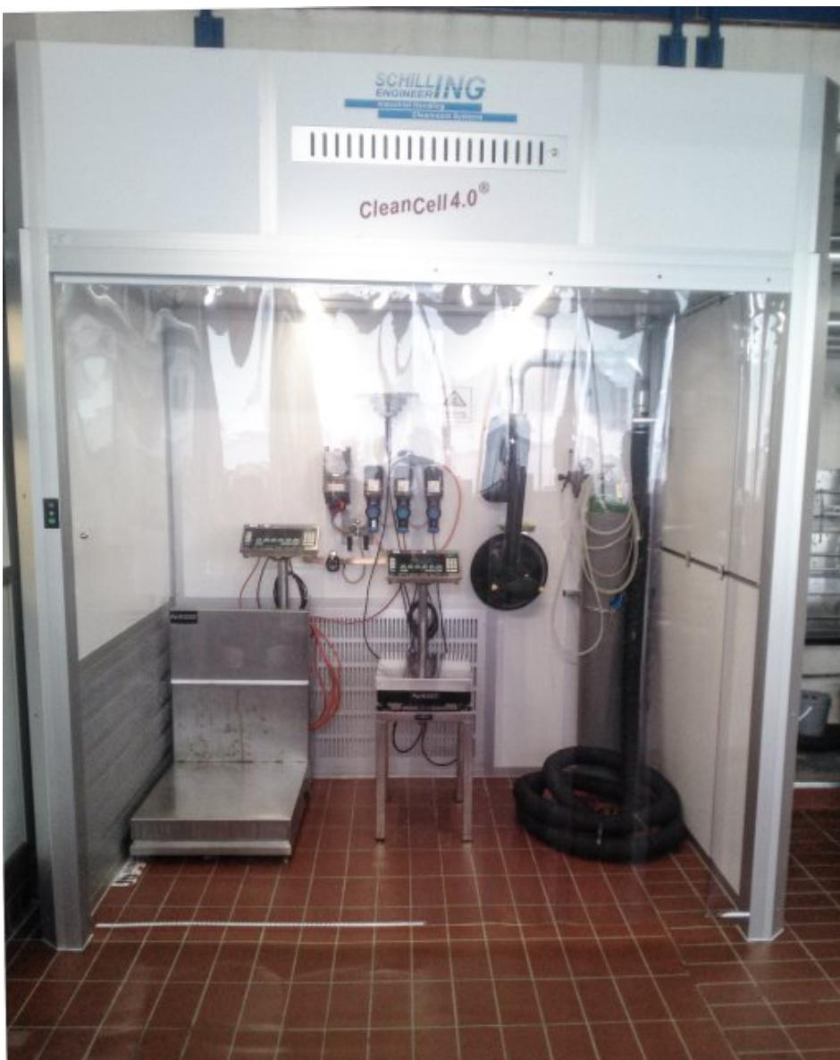
Die kompakte Reinraumanlage verhindert Kontaminationen bei der Pulverabfüllung
