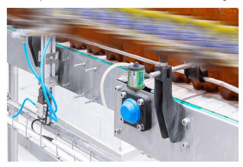
Der automatische Schmierstoffgeber arbeitet auch unter schwierigen Umständen zuverlässig (Bild: Sohm Schmierstofftechnik).
