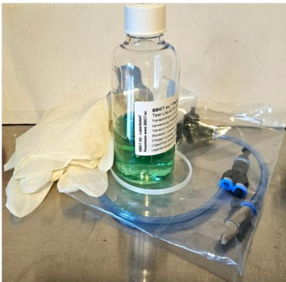
Der Druckgastest kann selbst oder in einem externen Labor ausgewertet werden (Bild: Peuker).
