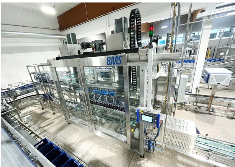
Beispiel für einen Sortierpacker (Bild: BMS Maschinenfabrik).
