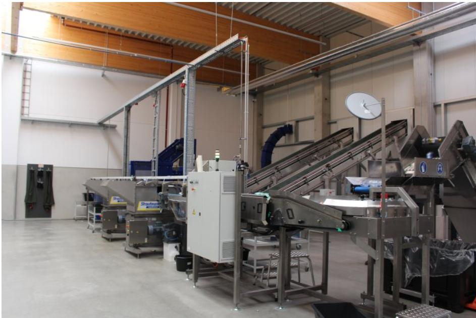
Die Entwässerung der Restflüssigkeiten erfolgt sauber und sicher über den »Liquidrainer« (Bild: Strautmann).
