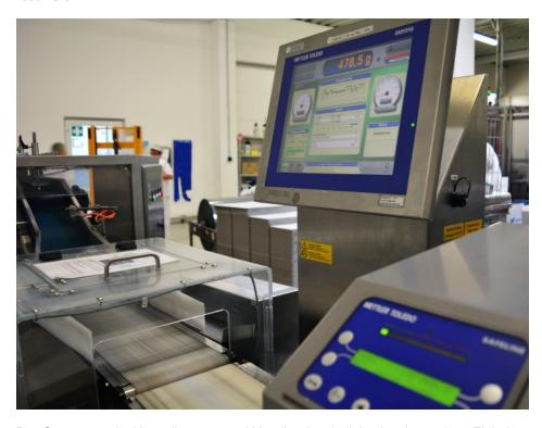
Das System vereint Kontrollwaagen und Metallsuchtechnik in einer kompakten Einheit (Bild: Mettler-Toledo).
