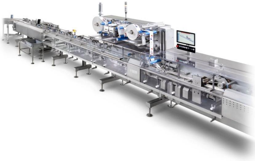
Die Schlauchbeutelmaschine bietet eine hohe Leistung und verarbeitet auch Papierfolien (Bild: Sacmi).
