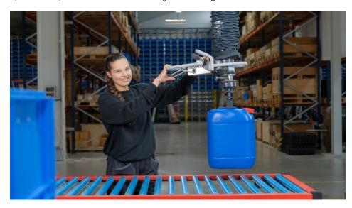
Durch die intuitive Zweihandbedienung können Hebegüter mit einem Gewicht von bis zu 65 kg ergonomisch bewegt werden (Bild: Timmer).
