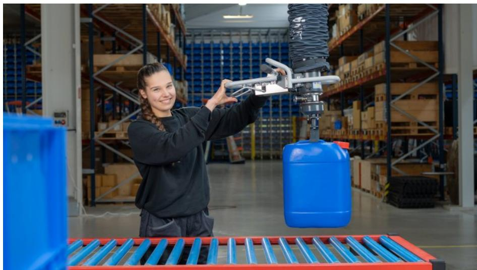
Durch die intuitive Zweihandbedienung können Hebegüter mit einem Gewicht von bis zu 65 kg ergonomisch bewegt werden (Bild: Timmer).
