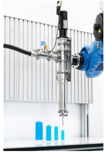
Die Dosier- und Abfüllpumpe ist kompakt und universell einsetzbar (Bild: Viscotec).
